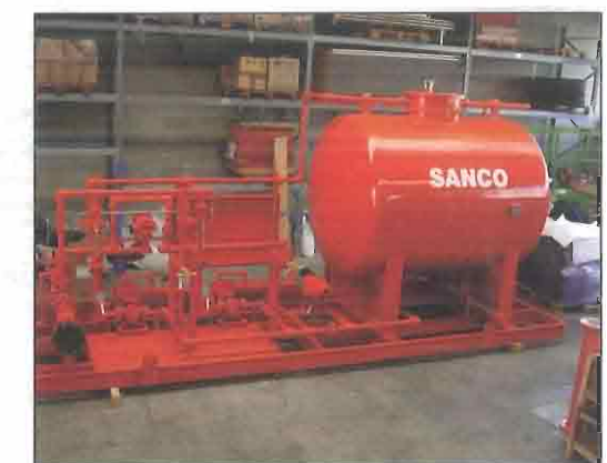
Skid schiuma con miscelazione a turbina idraulica.
