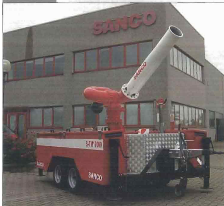
A sinistra il monitor carrellato Red Typhoon, in basso il rimorchio per liquido schiumogeno, capacità 10.000 l.
