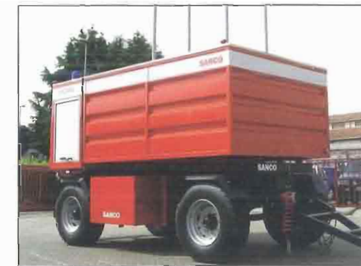
A sinistra il monitor carrellato Red Typhoon, in basso il rimorchio per liquido schiumogeno, capacità 10.000 l.
