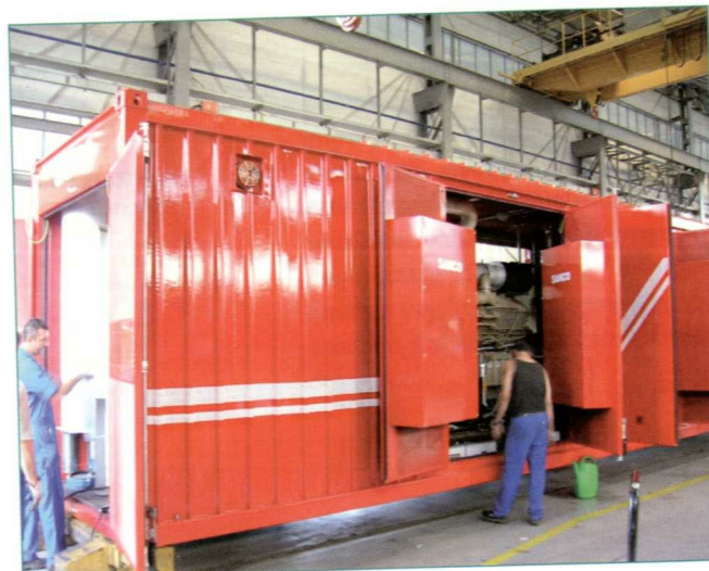
Fig. 1 Il gruppo antincendio SANCO "Red Hurricane" in costruzione presso la sede della Sanco
